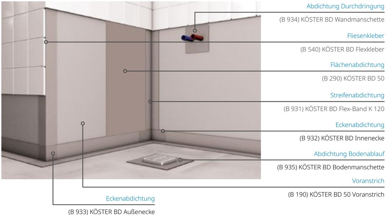
Nur wenige Bauteile sind so regelmäßig dem Wasser ausgesetzt wie Bäder und Feuchträume. Eine professionelle rissüberbrückende Abdichtung ist hier in jedem Fall erforderlich. Die Abdichtung soll zudem tragfähig genug sein, damit Fliesen auf die Abdichtung aufgebracht werden können.
