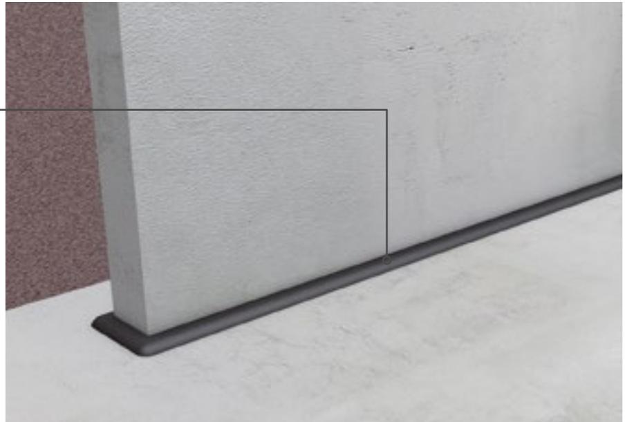
Die horizontale Abdichtung unter aufgehenden Wänden in der Neubauabdichtung ist erforderlich, um aufsteigende Feuchtigkeit im Mauerwerk oder in Betonwänden zu vermeiden. Hierfür ist eine ganze Reihe von Materialien von KÖSTER geeignet. KÖSTER Fixband 15 SY ist ein selbstklebendes Dichtungsband, welches einfach und schnell zu verarbeiten ist. Die
