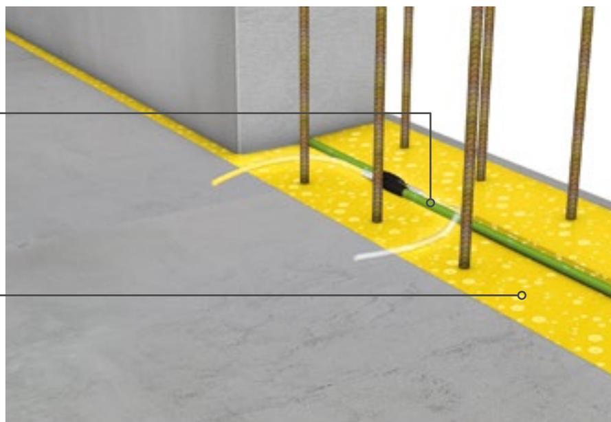
Arbeitsfugen, besonders bei Wand-/Sohlenanschlüssen, benötigen, soweit sie unterhalb der Geländeoberkante verlaufen, immer besondere Aufmerksamkeit, was Abdichtung angeht. Fehlstellen sind gerade in diesen Bereichen oft zu beobachten.
