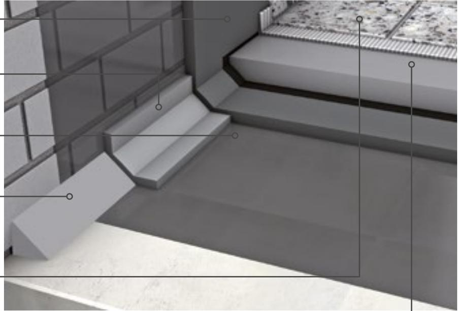
Balkone und Terrassen sind laufend dem Regen oder Spritzwasser ausgesetzt und unterliegen oft hohen Temperaturschwankungen. Die Abdichtung hat daher rissüberbrückend zu erfolgen.
