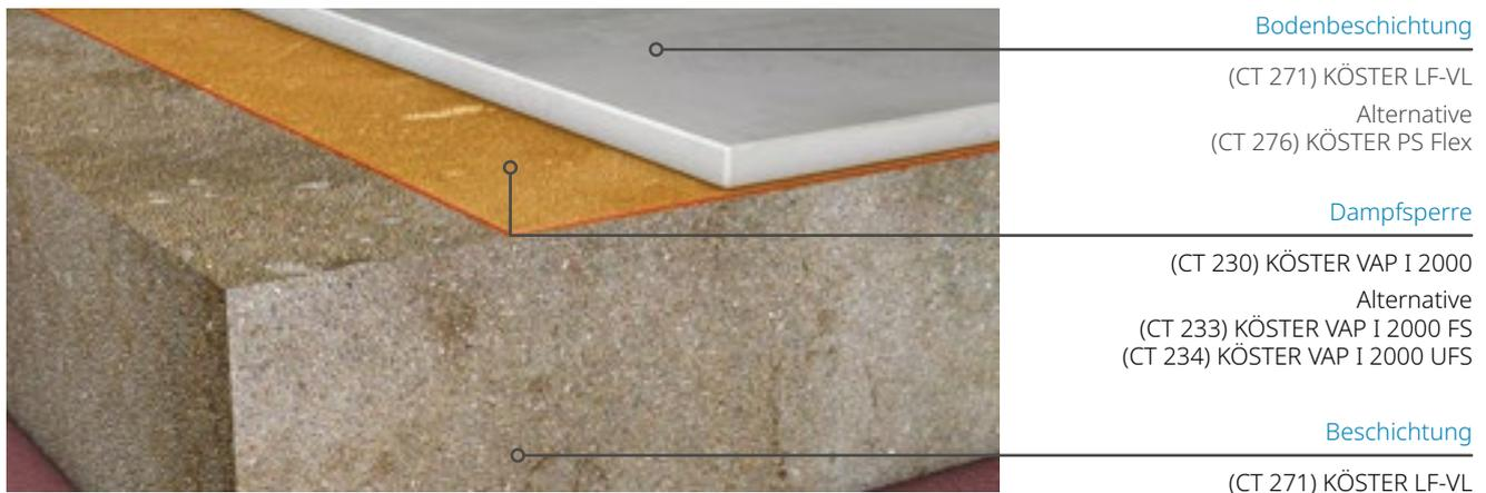
Betonböden mit rückwärtiger Durchfeuchtung können für nachfolgende Beschichtungen oder Bodenbeläge problematisch sein, da Feuchtigkeit und hohe Alkalität oft zu Ablösung von Beschichtungen oder zur sogenannten "osmotischen Blasenbildung" führen können. In solchen Fällen muss eine Grundierung erfolgen, die eine sehr große Haftung aufweist, die eine sehr hohe Dampfsperrewirkung hat und gegen
