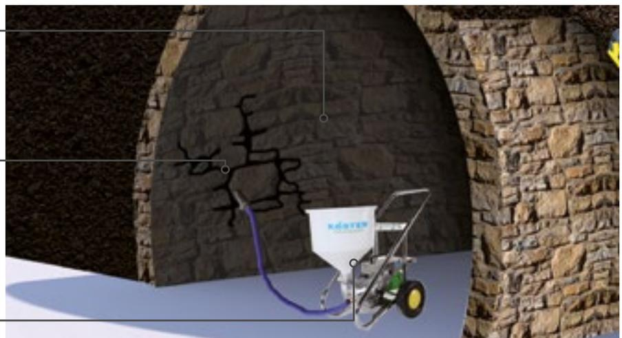
Auf der druckabgewandten Innenseite können verschiedene Abdichtungssysteme angewendet werden. KÖSTER Kellerdicht 2 Blitzpulver und KÖSTER Wasserstop können verwendet werden um kleine Wassereinträge zu stoppen. Fugen
