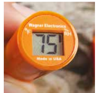
Der RH-Test (relative Betonluftfeuchte)
